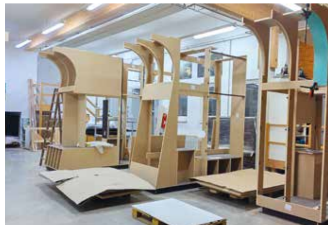
Jedes einzelne Modul war zuvor einmal in der Tischlerei komplett zusammen- und wieder auseinandgebaut worden, um die Passgenauigkeit zu überprüfen. Jede der sichtbaren Verkleidungsplatten ist mehrfach lasiert und anschließend von der Druckerei in einem mehrstufigen Verfahren bedruckt worden.
