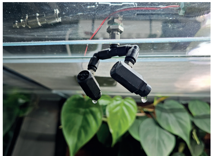
Austrittsdüsen einer Beregnungsanlage | Heiko Werning
